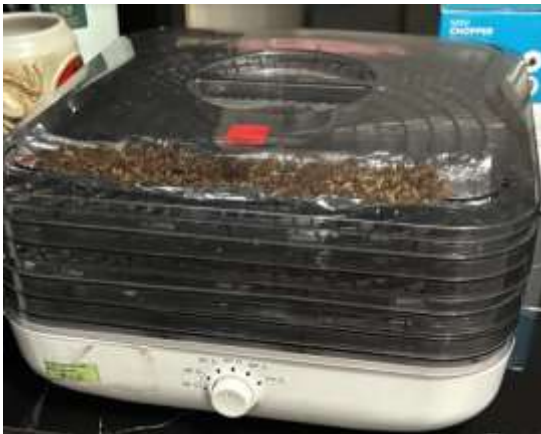
Figura 3. Deshidratación de bagazo de cebada Pilsen Rendón, 2024
