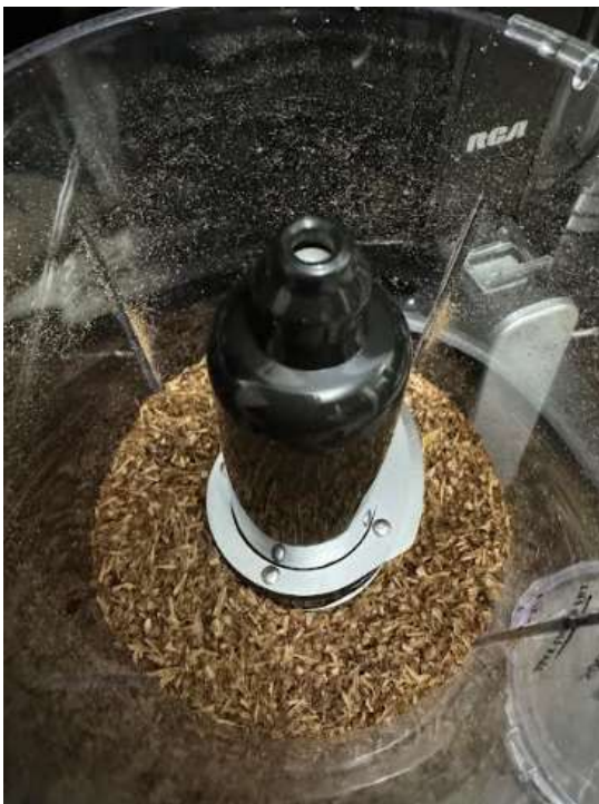
Figura 5. Proceso de trituración bagazo de cebada Pilsen Rendón, 2024
